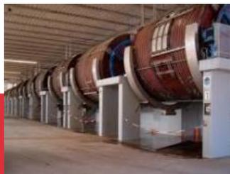
Le sostanze chimiche necessarie vengono selezionate in base alla quantità richiesta su un display per il dispensing automatico. Dopodichè, queste sostanze vengono trasportate al bottale tramite un tubo esterno, che le rilascia in un contenitore laterale al bottale. Qualora le sostanze abbiano bisogno di essere diluite, si può selezionare la quantità e la temperatura dell'acqua.
