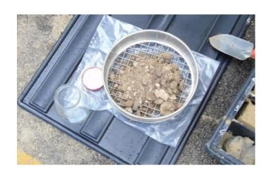
La formazione del campione da analizzare deve essere privato della frazione maggiore di 2 cm (da scartare in campo) e le determinazioni di laboratorio dovranno essere condotte sul'aliquota di granulometria inferiore ai 2 mm. La concentrazione del campione dovrà essere determinata riferendosi alla totalità dei materiali secchi comprensiva anche dello scheletro.
